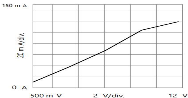
图5: VF-IF特性曲线
