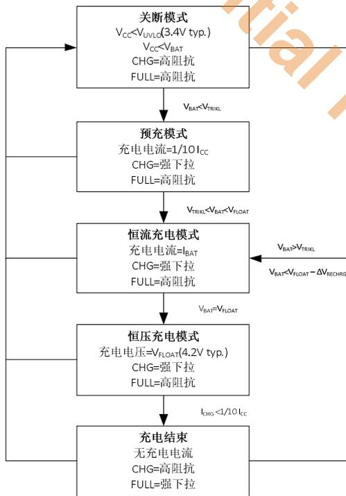
图 1: 一个典型充电循环的状态图
